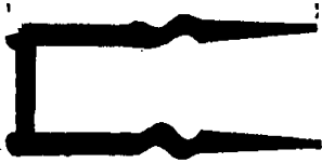
Re 1329 Cool room door gasket
